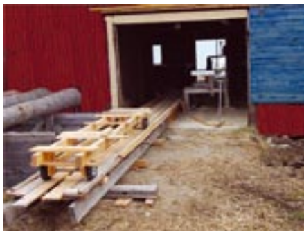
Stockvagnen utrullad. Lägg märke till överhänget på bordets översta plankor.
