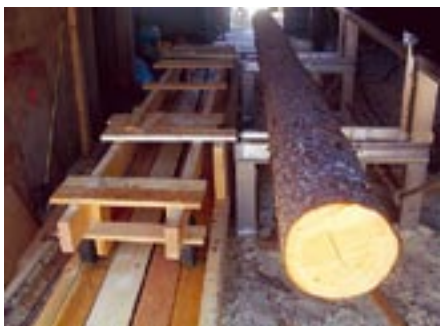
När stocken ligger på sågbordet blir vagnen upplag för bräder och plank.
