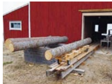
Överhänget placerar stocken mitt på vagnen, och en kloss hindrar den att falla av.
